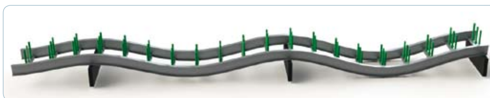
Determinación CTA en múltiples vanos (UNE-EN 61537)
